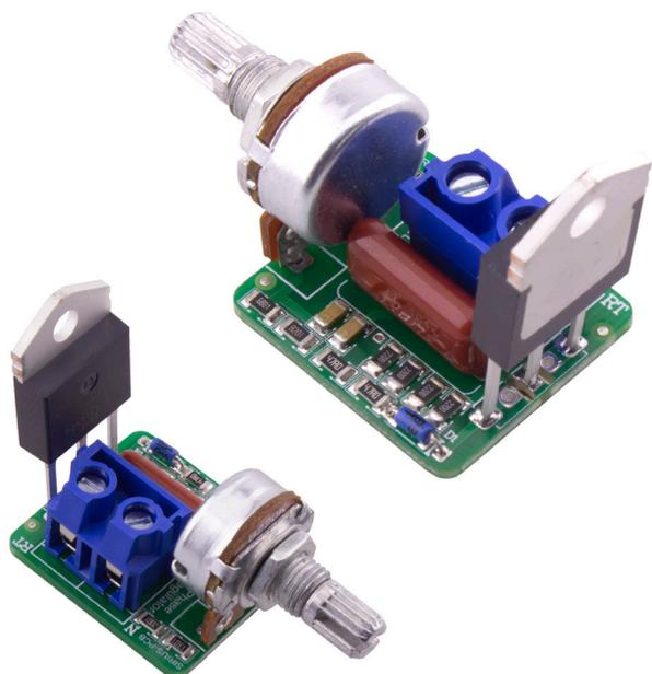
Устройството може да се използва като регулатор на обороти за дрелка, вентилатор, регулатор за осветление, регулатор на мощността на нагреватели и други консуматори, захранващи се от електрическата мрежа AC 230V. Схемата е реализирана с триак и диак, което позволява двупериодно регулиране със загуби до 3% и КПД 97%.
