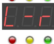
На дисплея се изписва **L-r**, (избор на тип **Left-Right**) и се визуализира текущата стойност на този параметър (цифрите започват да мигат). С параметъра може да зададете какво да се визуализира на дисплея в работен режим.
