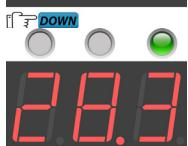
Докато устройството е в работен режим натиснете десния бутон **Up**, за да се визуализира текущата температура на десния сензор.
