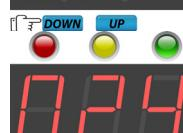
За записване на стойностите натиснете бутона **Set**, след което те се записват в енергонезависимата памет на микроконтролера.
