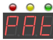
На дисплея се визуализира **PAt**, и се извежда текущата стойност на този параметър. Той задава времето в секунди, през което да се сменят показанията на двета сензора (само ако е избран тип **0** - последователна визуализация на двета сензора).
