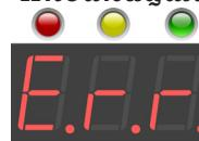
Индикация на устройството при загуба на връзка със сензор.
