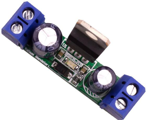
Устройството служи за филтриране и стабилизиране на DC напрежение. Стабилизаторът е изграден на базата на интегрална схема 7815. Намира своето приложение във връзка към устройства, нуждаещи се от захранване DC 15V и с максимален ток на консумация 1A като: MP3 плеъри, микроконтролери и др. електронни устройства.
