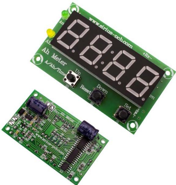
Устройството е изграден на базата на съвременен микроконтролер и е предназначен за измерване на електрически ток (**A**) и електрическа енергия (**Ah**). Намира своето приложение при електрохимични системи като галванизация, измерване на капацитет на акумулатори и др.
