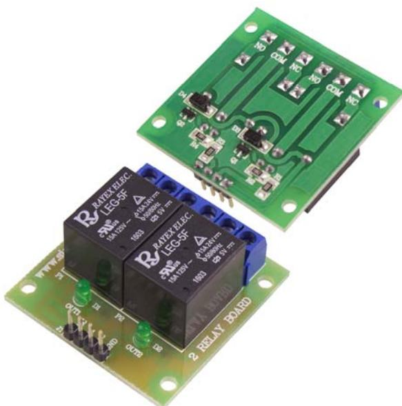
Модулът е изграден от две електромагнитни релета, работещи на 5V, управлявани от два NPN транзистора, монтирани върху платка. Модулът намира приложение, като електронен ключ, прекъсвач, при управление на мощни консуматори (вентилатори, мотори, лампи, мощни светодиоди и др.) от микроконтролер и др.
