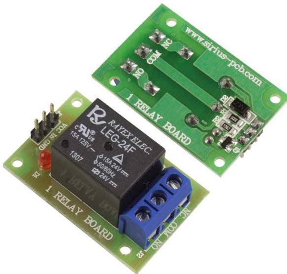
Модулът е изграден от електромагнитно реле, работещо на 24V, управлявано от NPN транзистор, монтирани върху платка. Модулът намира приложение, като електронен ключ, прекъсвач, при управление на мощни консуматори (вентилатори, мотори, лампи, мощни светодиоди и др.) от микроконтролер и др.
