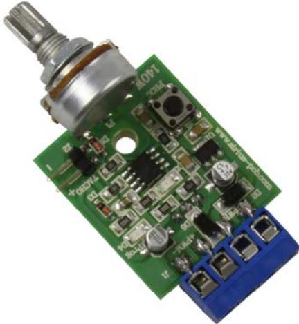
Устройството представлява PWM регулатор на обороти на постоянно токов електромотор със запазване на въртящия момент и обратна връзка от тахогенератор. Изграден на базата на съвременен микроконтролер.
