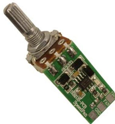
Електронният регулатор на обороти е базирани на интегрална схема и работи на принципа на PWM, като регулирането на оборотите се извършва посредством потенциометър.
