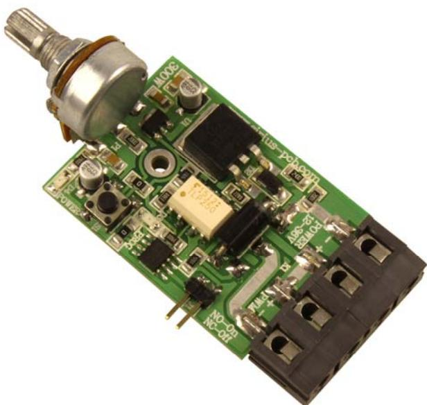
**PWM DC 300W** е изграден на базата на съвременен микроконтролер и SMD компоненти, което води до значително намаляване на размерите на устройството и повишаване на неговата стабилност. С устройството могат да се управляват оборотите на DC мотор или силата на светене на светодиоди.
