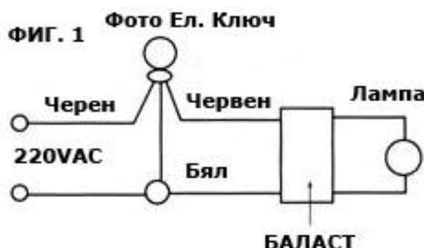
На ФИГ.1 е показана схема на свързване на фотоелектричният ключ при употреба на луминисцентно или живачно осветление. Моля имайте в предвид, че такъв тип осветления са индуктивен товар.
