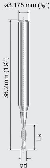
Hartmetall-Fräser mit 2 Hauptschneiden, rechts-schneidend, Hauptschneiden rechts-spiralisiert und scharfgeschliffen (Schnittdruck nach oben) mit Fischeschwanzanschweif.
