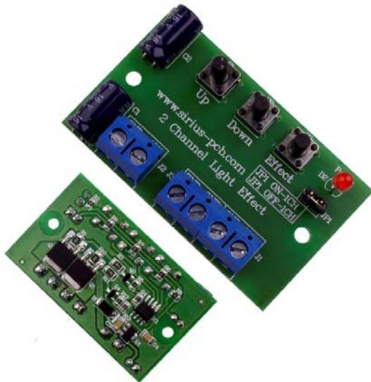
Устройството е изградено на базата на съвременен микроконтролер и представлява двуканално устройство за светлинни ефекти.
