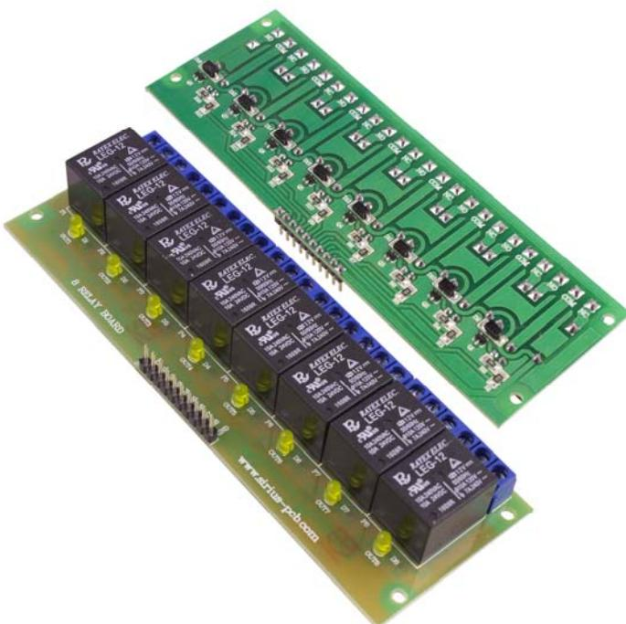
Модулът е изграден от осем електромагнитни релета, работещи на 12V, управлявани от осем NPN транзистора, монтирани върху платка. Модулът намира приложение, като електронен ключ, прекъсвач, при управление на мощни консуматори (вентилатори, мотори, лампи, мощн светодиоди и др.) от микроконтролер и др.
