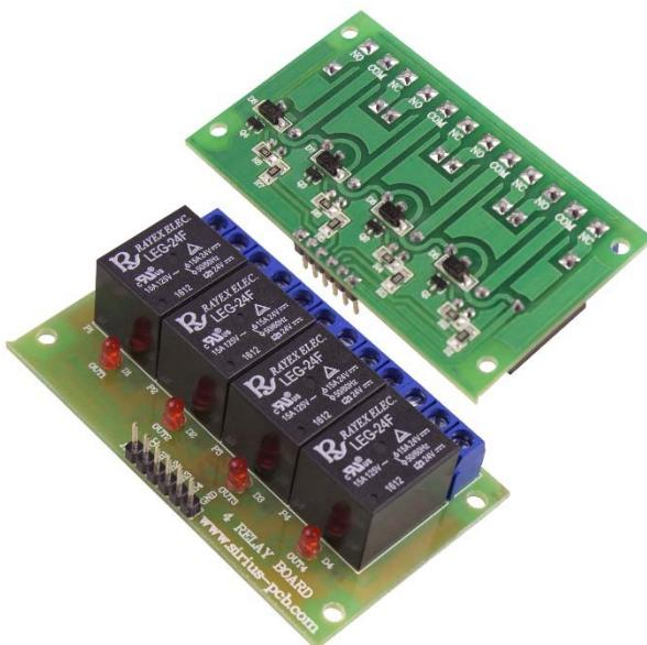
Модулът е изграден от четири електромагнитни релета, работещи на 24V, управлявани от четири NPN транзистора, монтирани върху платка. Модулът намира приложение, като електронен ключ, прекъсвач, при управление на мощни консуматори (вентилатори, мотори, лампи, мощни светодиоди и др.) от микроконтролер и др.
